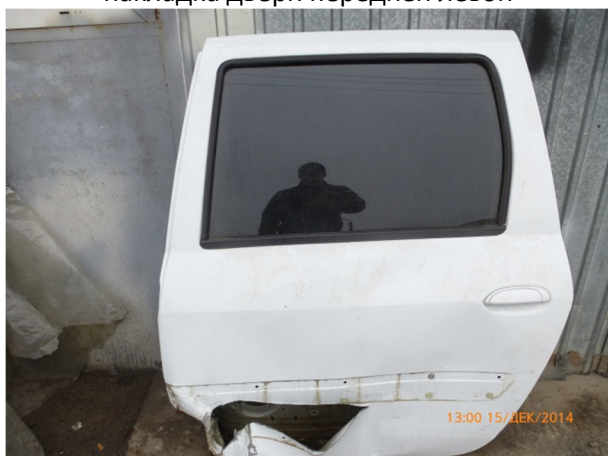
Фото № 11. Дверь задняя левая, защитный молдинг двери задней левой (отсутствует, утерян)
